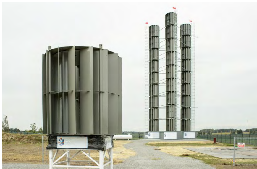
Rys. 9.5 Konstrukcja wiatraka o osi pionowej.
